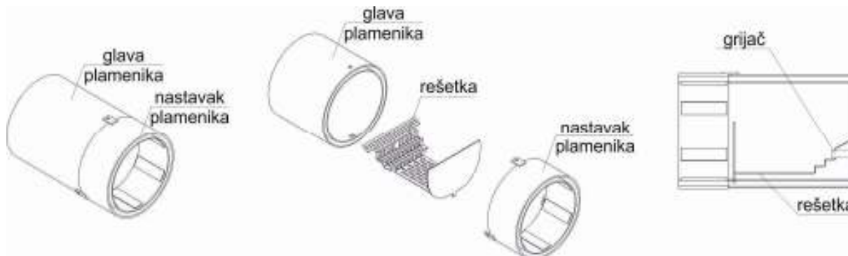
Vađenje prednjeg poklopca plamenika radi lakšeg čišćenja i ispravan položaj rešetke
